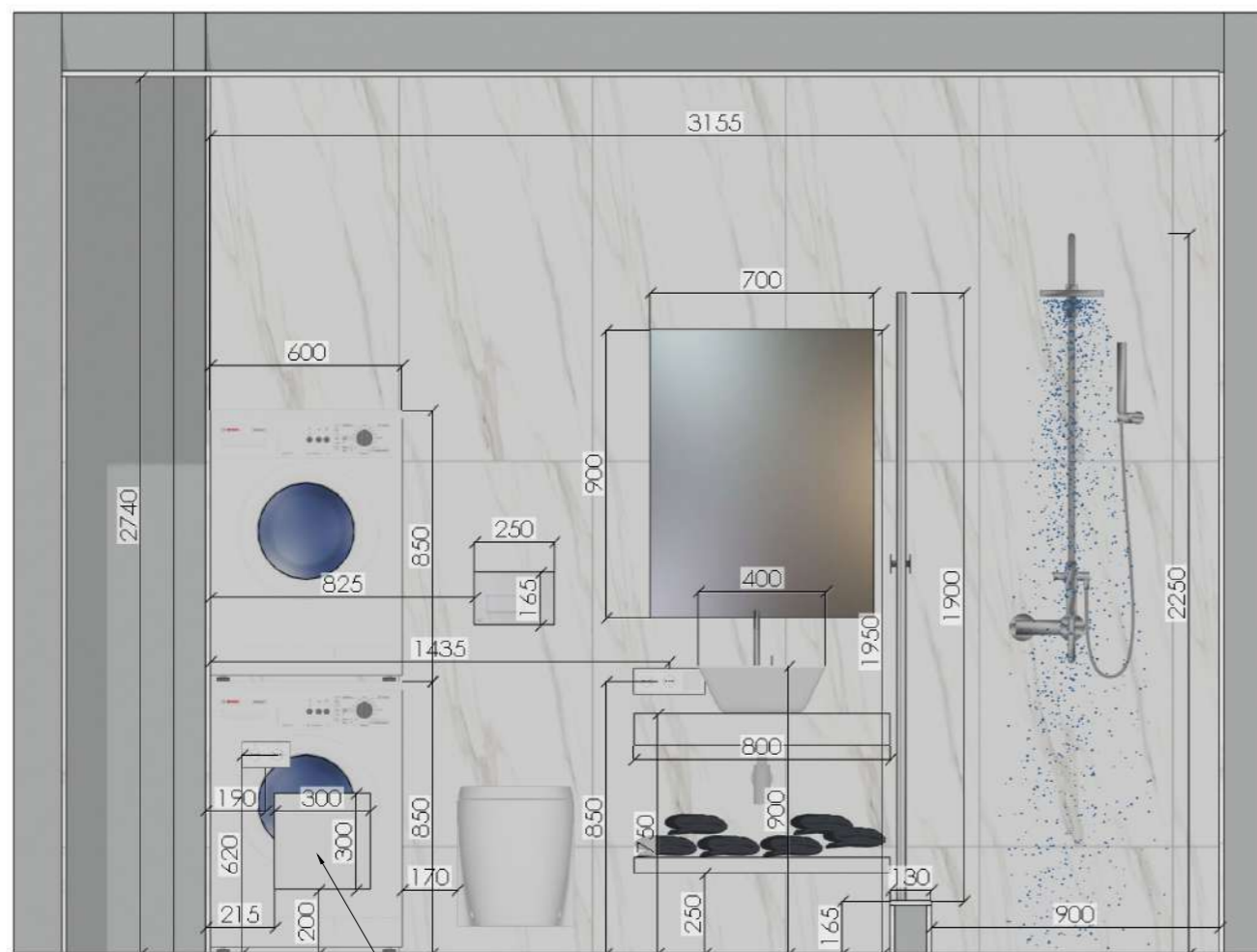
Развёртка стены гостевого санузла №16
